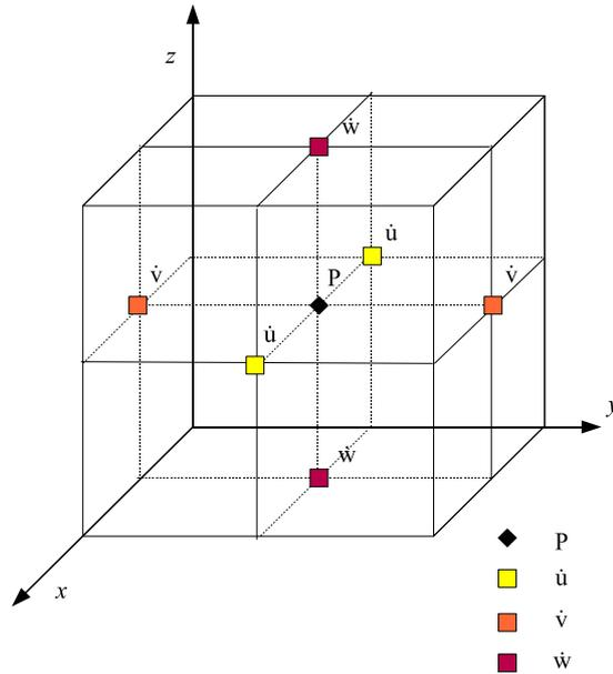
図 1.2: 音波の圧力と変位ベクトルを離散化しグリッドに並べた図
