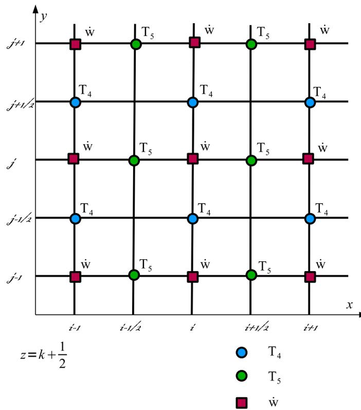
図 1.4:  $z = k + 1$  面における離散化の図 . せん断応力  $T_4, T_5$  及び粒子速度  $\dot{w}$  を格子上に配置する .
