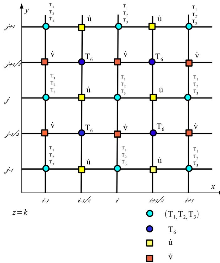
図 1.3:  $z = k$  面における離散化の図．垂直応力  $(T_1, T_2, T_3)$  , せん断応力  $T_6$ , 粒子速度  $\hat{u}, \hat{v}$  を各格子上に配置する．
