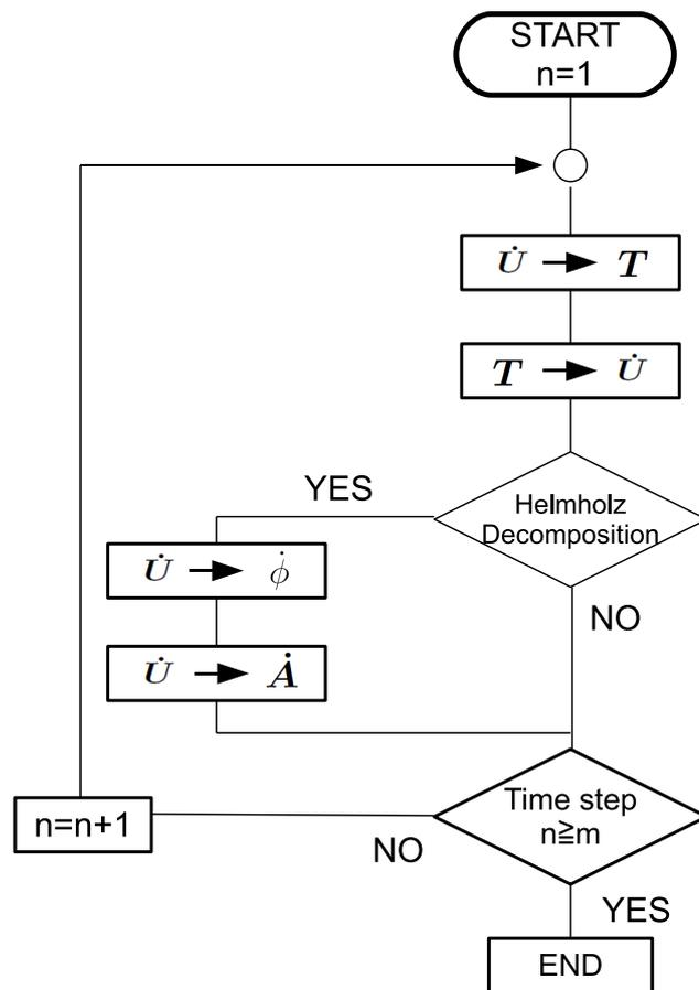
図 1.1: 計算のフローチャート図. 粒子速度ベクトル  $\dot{U}$  から半ステップ時間後の応力  $T$  が計算される。この応力ベクトルから粒子速度が計算され時間ステップを更新する。ヘルムホルツ分解をする場合は, 関数を呼び出し粒子速度ベクトル  $\dot{U}$  からスカラー及びベクトル速度ポテンシャル  $\dot{\phi}, \dot{A}$  が計算される。
