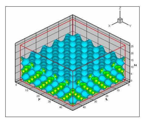
次に水素終端シリコン(001)表面からおよそ 5Å上方での電子状態密度をお見せします。バルクでのフェルミエネルギーから、その上方1.5eV までのエネルギー帯域、つまり、伝導バンドの底部近傍における電子状態密度の積分値を表示しています。赤が値の大きいところであり、黄、緑、青となるにしたがって減少していきます。なおこの図は、トンネル電流の強さを見ていることにもなっております。(ただし、STM チップ先端付近の電子の波動関数が等方的な場合に対応します。)その場合、赤い箇所にチップがあるときには電流が強い、青い箇所にあるときは弱い、ということになります。
