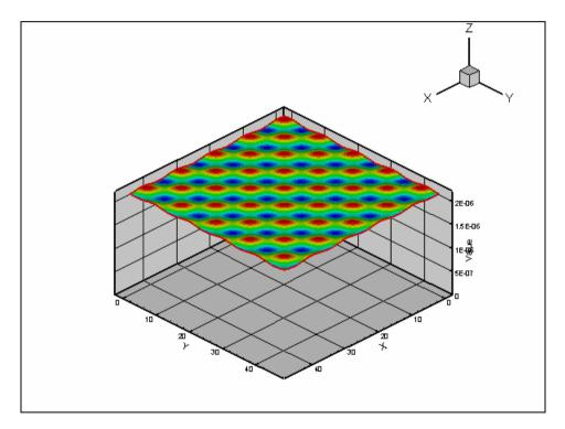
また、不純物を入れた場合にも同様の計算が可能です。以下の図は、 不純物としてドナーをバルク層と表面層の境界からおよそ 5Å下方に入 れた場合の、ドナーによる変化のみを取り出した結果です。先ほどと 同様、水素終端シリコン(001)表面からおよそ 5Å上方、バルクでのフェルミエネルギーから、その上方 1.5eV までの電子状態密度の積分値であり、 チップ先端付近での電子の波動関数が等方的な場合に流れるトンネル電流の強さを表しています。ドナーの存在がトンネル電流値に反映されることが解ります。
